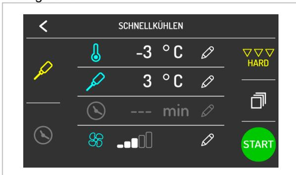
In diesem Fenster können Sie verschiedene Parameter bezüglich der Schnellkühlphase einstellen (siehe Kapitel "Temperaturgesteuertes Schnellkühlen").
