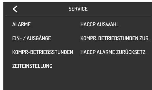
Um auf dem Menü "Zurückstellung der Betriebsstunden des Kompressors" und "Zurückstellung der HACCP Fehlermeldungen" zuzugreifen, ist das Passwort **149** erforderlich.
