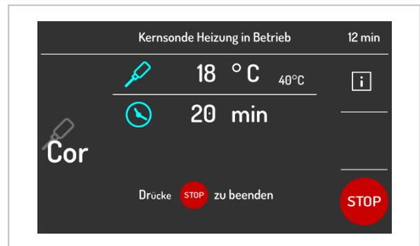
Beim drücken auf dem Bereich **i** kann man die von den Fühler gelesene Temperatur, der Stand der Ein- und Ausgänge und die vom System gespeicherten Fehlermeldungen aufrufen.
