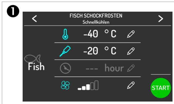
Das Drücken des Bereichs -40 °C ermöglicht die Änderung der Betriebstemperatur der Zelle während der Schnellkühlphase.
